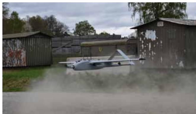
**Eine mit Sensoren ausgestattete Drohne beim vertikalen Start.**
