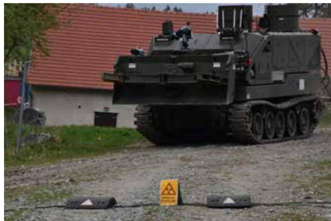
**Dieses unbemannte Gerät bewegt sich im verstrahlten Gebiet. Es kann Bodenproben entnehmen und bei Bedarf einfache Dekontaminationsaufgaben durchführen.**
