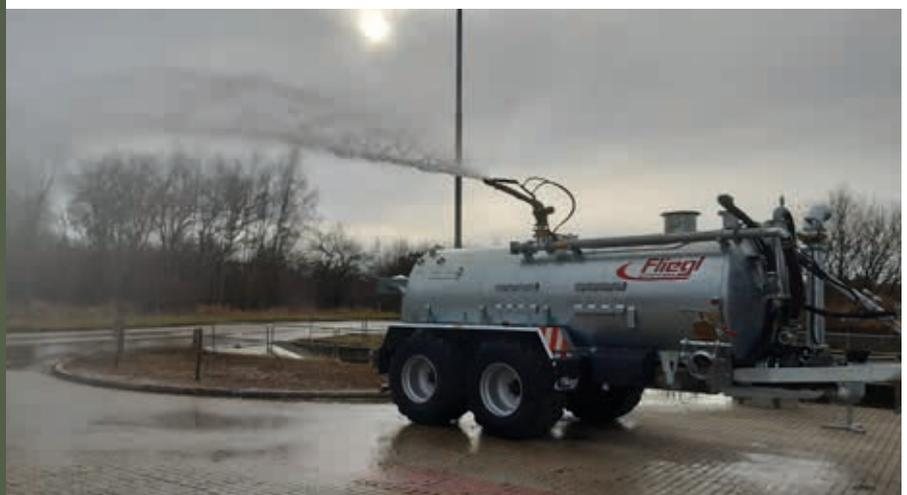
Die Regnerdüse ist sehr flexibel, nämlich hydraulisch schwenkbar 360° und nach oben und unten verstellbar.
