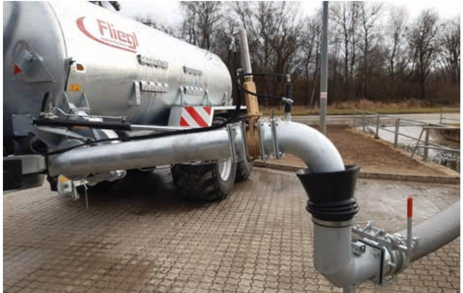
Die Andockstation mit dem hydraulischen Saugrüssel für schnelles befüllen.
