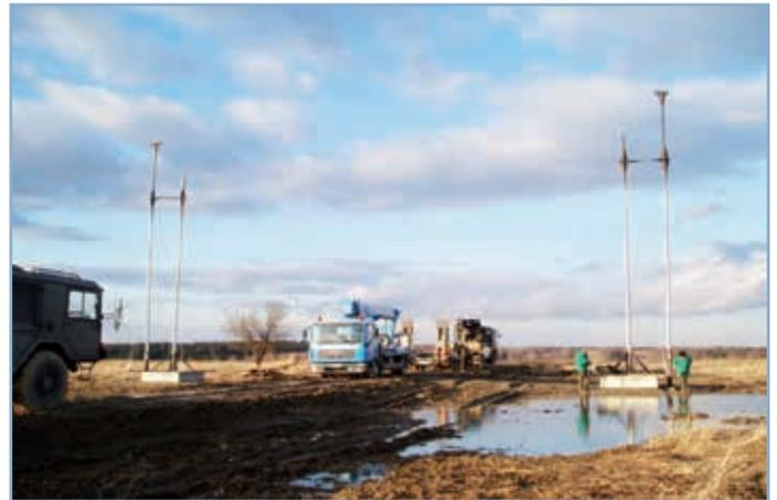
Foto oben: Industrieherdplatten auf Stahlmasten dienen als Hitzequelle und Ziel für die Lenkwaffe.
