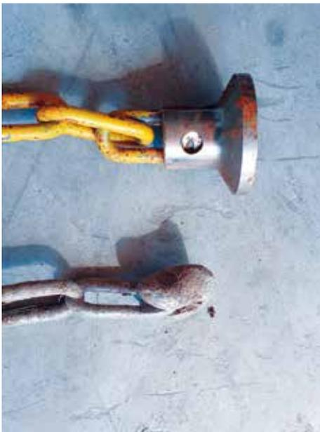
Für die Maschinenteile ist es eine enorme Beanspruchung. Am Bild Minenschlegel vor und nach ihrem Einsatz.
