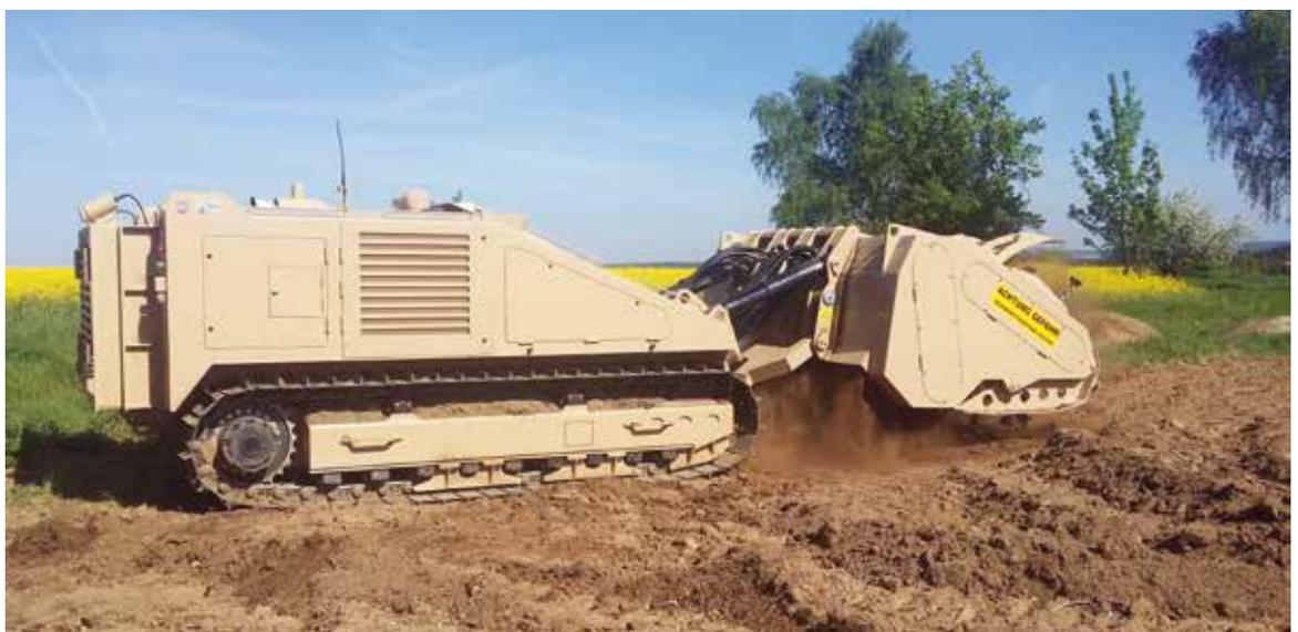
bei einer Bearbeitungsbreite von ca. 3 m eine  $m^2$  Leistung von ca. 1200  $m^2$  bei optimalen Bodenverhältnissen in der Stunde zulassen würde. Bereits 86.542  $m^2$  konnten in den ersten drei Wochen bearbeitet, vermessen und dem TÜPI A übergeben werden.
