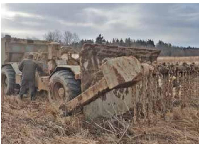
▲ Hydrema 910 MCV-2 nach Bearbeitung eines Teilstückes des Brandschutzstreifens
