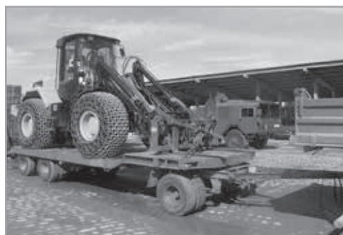
JCB - Grabenbagger verladen und verzurt
